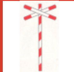
Overweg met enkel spoor
