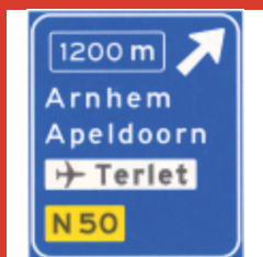
Voorwegwijzer langs autosnelweg voor de afgaande richting, met afstand-aanduiding, interlokale doelen (bovenste doel = afritnaam), verwijzing naar vliegveld/luchthaven en routenummer niet-autosnelweg
