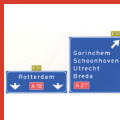
Hoge beslissingwijzer langs autosnelweg met rijstrookpaneel voor de doorgaande richting en aftakkingpaneel voor de afgaande richting, met interlokale doelen, routenummers autosnelwegen en Europese hoofdroutes
