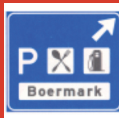
Beslissingwijzer langs autosnelweg voor de afgaande richting naar een verzorgingsplaats, met de naam van de parkeerplaats en symbolen die de aard van de voorzieningen aangeven
