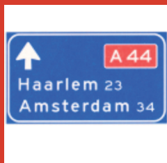
Lage beslissingwijzer langs autosnelweg voor de doorgaande richting, met interlokale doelen en routenummer autosnelweg
