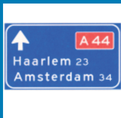
Lage beslissingewegwijzer langs autosnelweg voor de doorgaande richting, met interlokale doelen en routenummer autosnelweg
