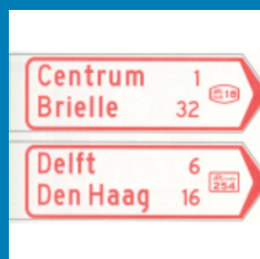
Wegwijzer voor fietsers en bromfietzers (handwijzer), met lokaal doel, interlokaal doel, stedelijk fietsroutenummer (boven), en met interlokale doelen en interlokaal fietsroutenummer (onder)
