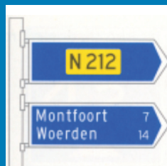
Beslissingewegwijzer langs niet-autosnelweg met interlokale doelen en routenummer niet-autosnelweg
