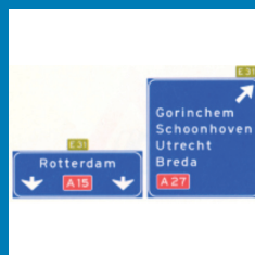
Hoge beslissingewegwijzer langs autosnelweg met rijstrookpaneel voor de doorgaande richting en aftakkingpaneel voor de afgaande richting, met interlokale doelen, routenummers autosnelwegen en Europese hoofdroutes
