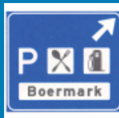
Beslissingewegwijzer langs autosnelweg voor de afgaande richting naar een verzorgingsplaats, met de naam van de parkeerplaats en symbolen die de aard van de voorzieningen aangeven
