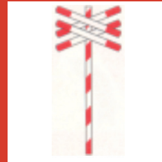
Passage à niveau, plusieurs voies
