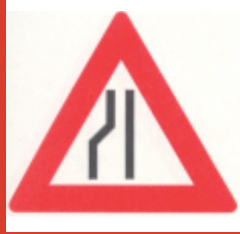
Chaussée rétrécie à droite
